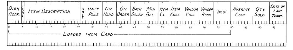
FIGURE 19. TRACK LAYOUT OF AN ITEM RECORD IN THE DISK STORAGE
