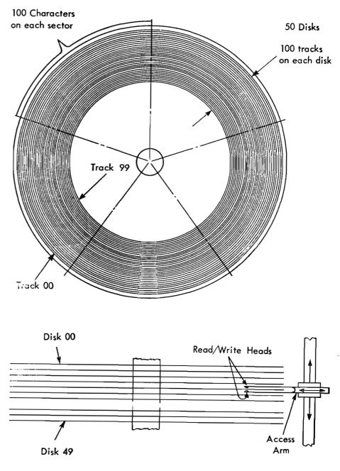
FIGURE 4. SCHEMATIC OF DISK STORAGE
